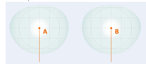
Ryc. 1. Promienie światła przechodzą przez soczewkę w tym samym miejscu dla prawego i lewego oka
